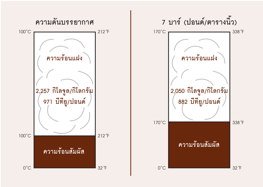
รูปที่ 2 การเปรียบเทียบความร้อนแฝงของไอน้ำที่กั้นตัวที่ความดันบรรยากาศ และที่ 7 บาร์ (100 ปอนด์/ตารางนิ้ว)
